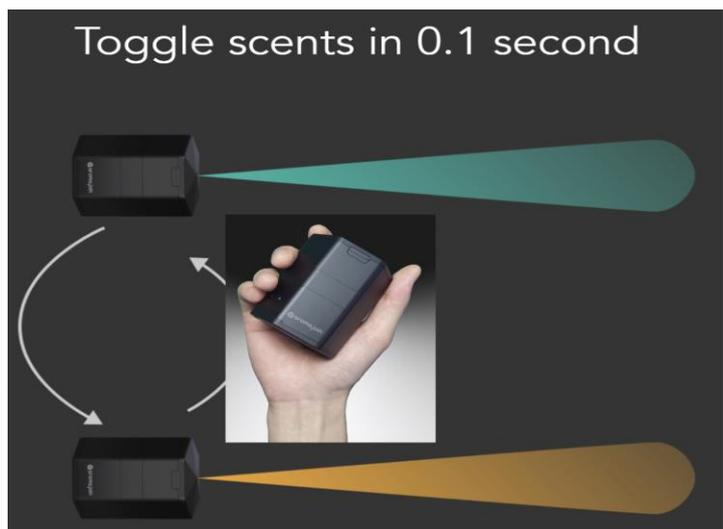
**Aroma-Shooter®:** Ein neuartiger Aromadiffusor, der auf flüssige und gasförmige Medien (Öle, Nebel, Dampf, Dunst etc.) verzichtet. Dies ermöglicht ein schnelles Umschalten diskreter Düfte und die sofortige Erzeugung von Aromamischungen. **Bild: MRU/Aromashooter**
