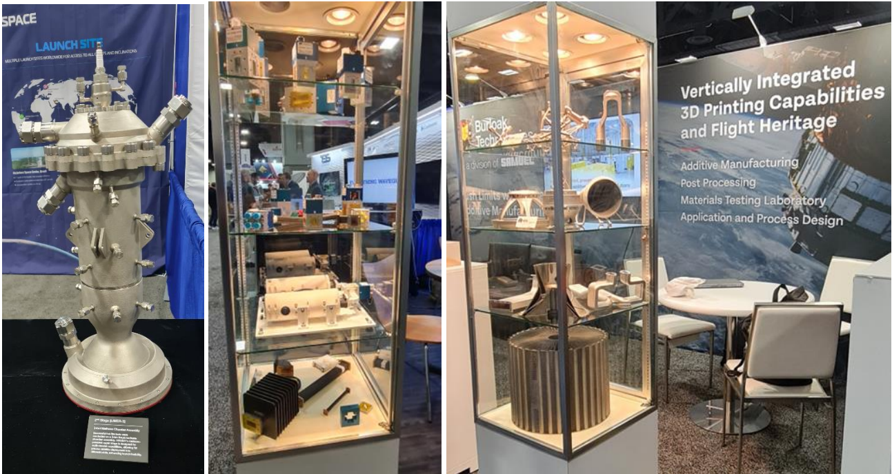
An dieser Ausstellung gibt es statt nur immer KI und Software richtige Hardware zu sehen: (Links) 2. Raketstufe (Limer 3) mit 3 Tonnen Schub. (Mitte) Klassisch hergestellte RF-Komponenten. (Rechts) Komponenten aus 3D Printing.
